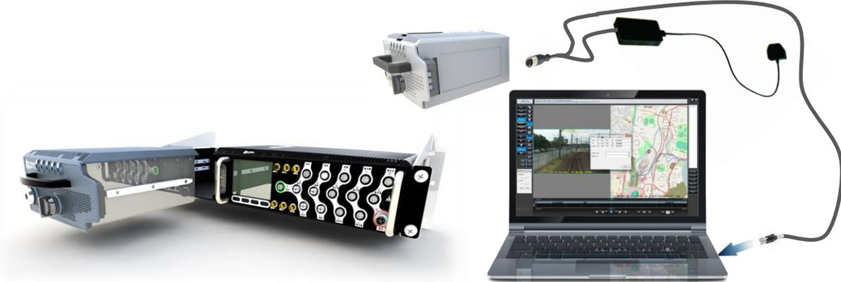
Der abschließbare Massenspeicher-Wechselrahmen des TDR6 kann schnell entfernt und zur Wiedergabe von Audio-, Video- und Datenströmen an einen Laptop- oder Desktop-PC angeschlossen werden
